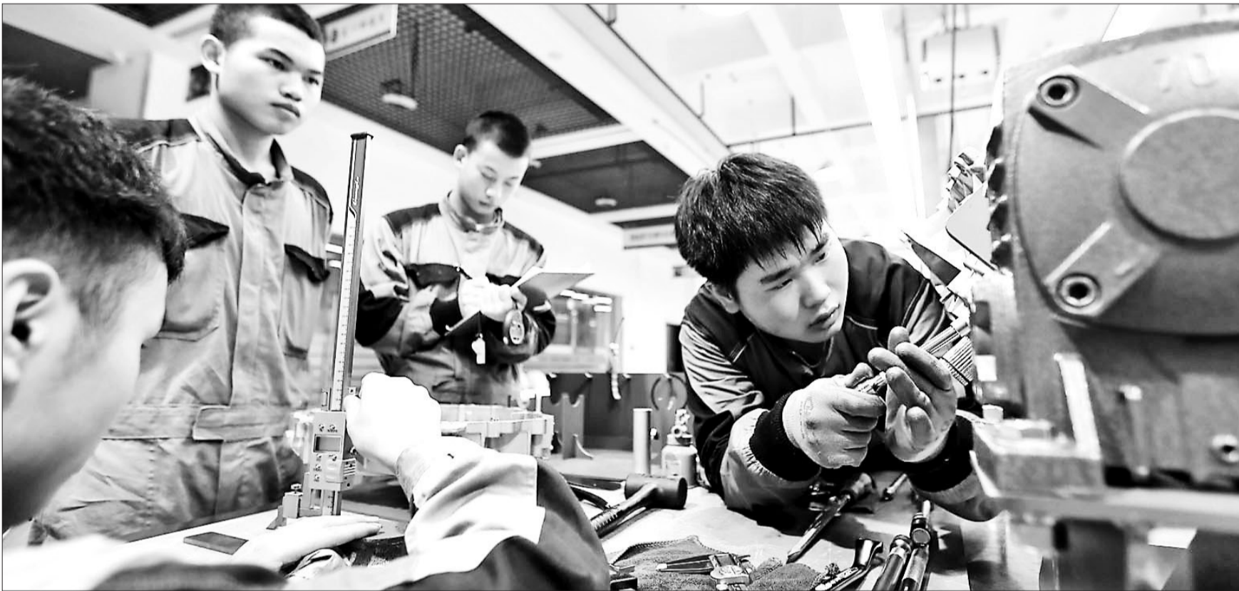
重庆一职业教育中心新能源汽车实训中心,学生正在组装新能源汽车减速器。
