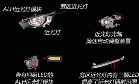
ALH自适应LED阵列前大灯的构成
